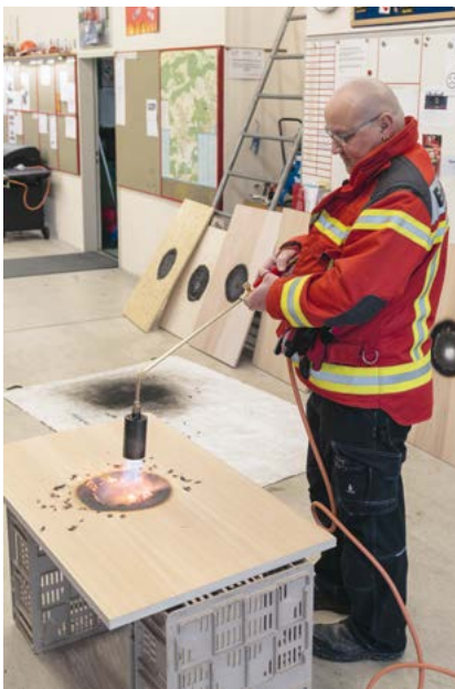
Diverse Platten im Feuerstest (3 Min. Brennzeit) mit dem Gasbrenner.
