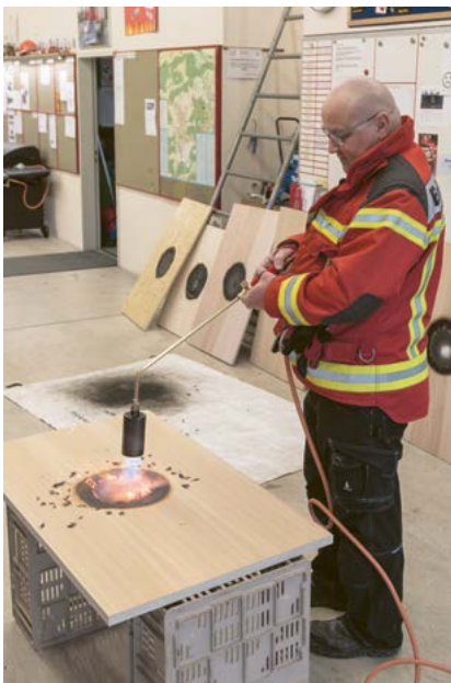
Diverse Platten im Feuertest (3 Min. Brennzeit) mit dem Gasbrenner.
