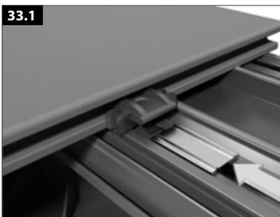
Avant le montage des lames, l'élément de fixation est inséré dans la rainure de montage et poussé jusqu'au clip de montage.
