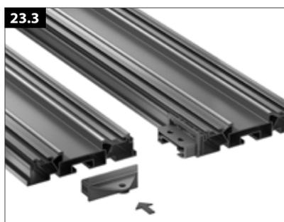
Le raccord d'angle est inséré dans les canaux des profilés de sous-construction.
