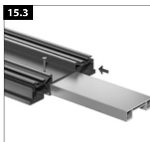
Dans le cas des profilés de sous-construction de 35 x 160 mm et de 80 x 160 mm, le raccord est vissé par le haut.
