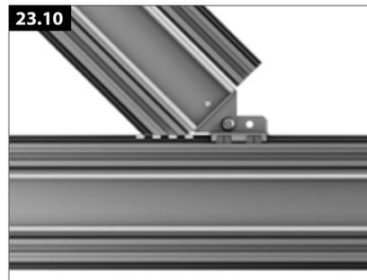
Le coin du profilé de sous-construction doit être découpé en fonction de la taille de l'angle.
