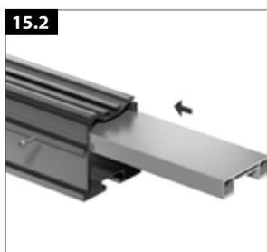
Dans le cas des profilés de sous-construction de 35 x 80 mm et de 80 x 80 mm, le raccord de profilé est vissé sur un côté dans la zone de l'entaille.
