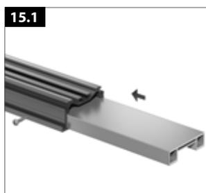
Le raccord de profilé est à moitié (20 cm) inséré dans les profilés de sous-construction.
